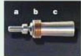
Il raccordo filettato viene fissato alla pompa idraulica e successivamente infilato nel tubo ad una profondità minima di circa 45 mm (1.3/4") rimanendo comunque necessariamente in zona piastra per garantire un sicuro ancoraggio.
